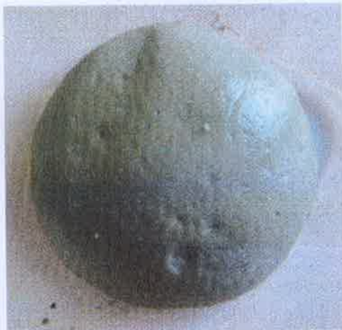
Foto 1 und 2: Untersuchungsmaterial RAKU-PUR 32-3276, Hellgrau nach einer Inkubationszeit von 28 Tagen ohne sichtbaren Pilzbewuchs
